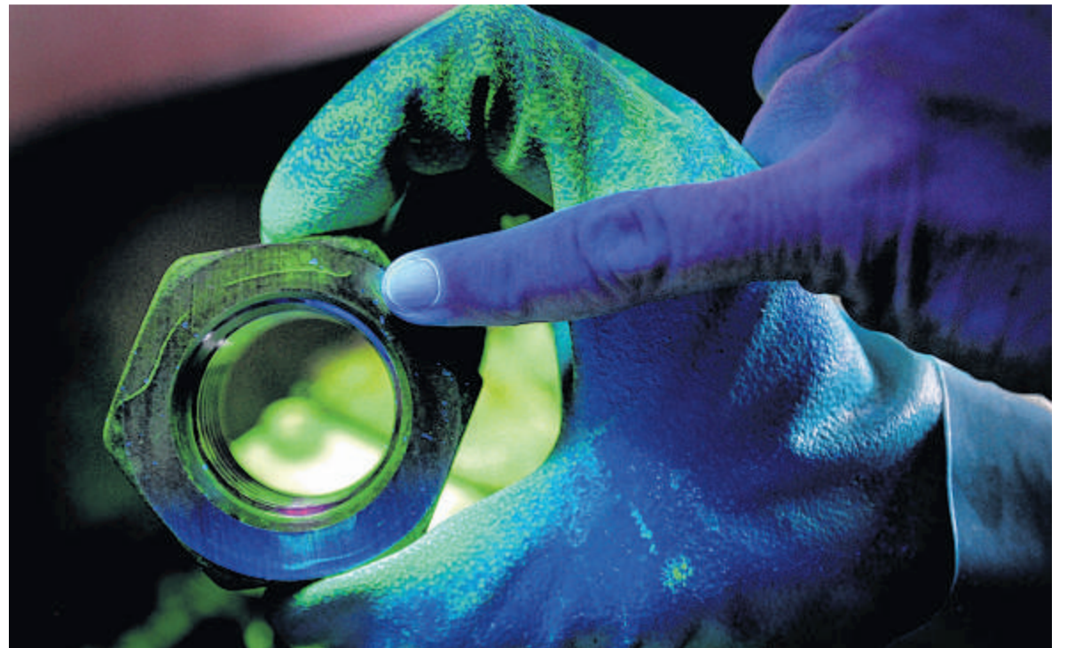
Qualitätskontrolle wird bei der Robert Grass GmbH in Delstern groß geschrieben. Hier kommt bei der Kontrolle einer Mutter UV-Licht zum Einsatz.
